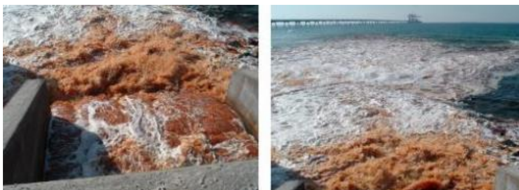
شکل ۴. تخلیه دوره‌ای آب فیلتریک‌واش از کارخانه نمک‌زدایی آشکلون در فلسطین اشغالی (برگرفته از Lattemann & El-Habr, 2009)
